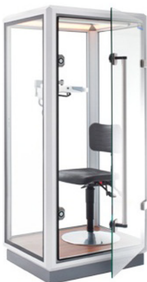
Die Bodyplethysmographie (große Lungenfunktionsmessung) ist ein Verfahren zur Messung von Lungen- und Atemparametern. Eine Vielzahl der ermittelbaren Werte, wie z.B. der Atemwiderstand, das Residualvolumen oder die totale Lungenkapazität, sind über die Spirometrie (kleine Lungenfunktionsmessung) nicht möglich.
